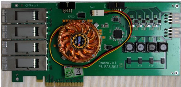
Рис. 1. Прототип платы разрабатываемого интерконнекта
